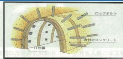
吹付けコンクリート・ロックボルト NATM工法(山岳工法)
